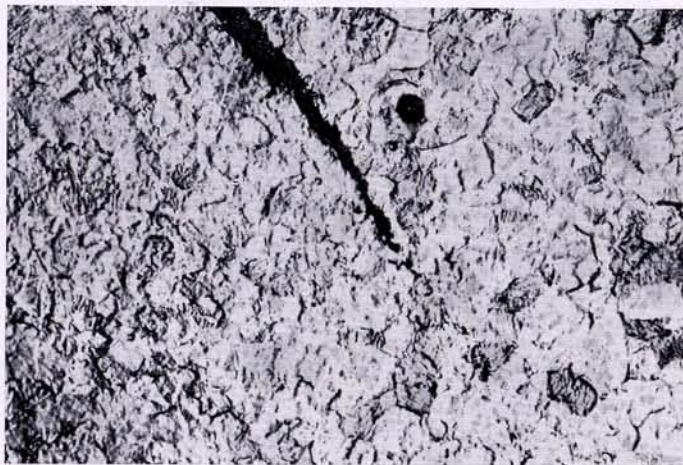
Micrografia di saldatura Zircaloy-Zircaloy eseguita dal Laboratorio di Tecnologie. Fotografia in campo chiaro con illuminazione obliqua.
