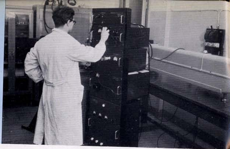
Spettrografo a grande dispersione e apparecchiatura elettronica per la ripresa automatica degli spettrogrammi per l'analisi delle impurezze dell'U (Laboratorio Spettrografico).
