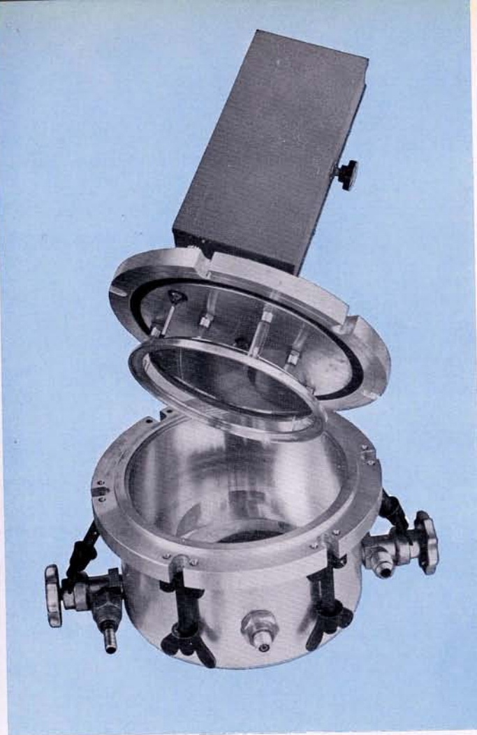
Camera di ionizzazione per lo studio di minerali radioattivi progettata e costruita dal Laboratorio di Fisica Nucleare
