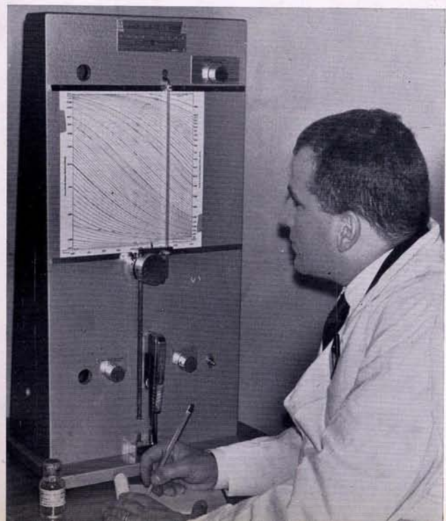
Apparecchio Fisher Sub-Sieve Sizer per la misura del diametro medio e della superficie delle polveri (Laboratorio di Tecnologie).
