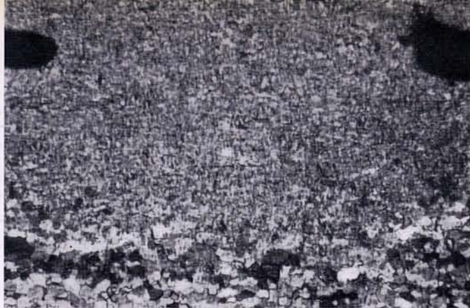
Micrografia di una saldatura Zircaloy-Zircaloy (senza ricottura del giunto) eseguita dal Laboratorio di Tecnologie. Notasi la perfetta giunzione dei lamierini. Fotografia eseguita con luce polarizzata.
