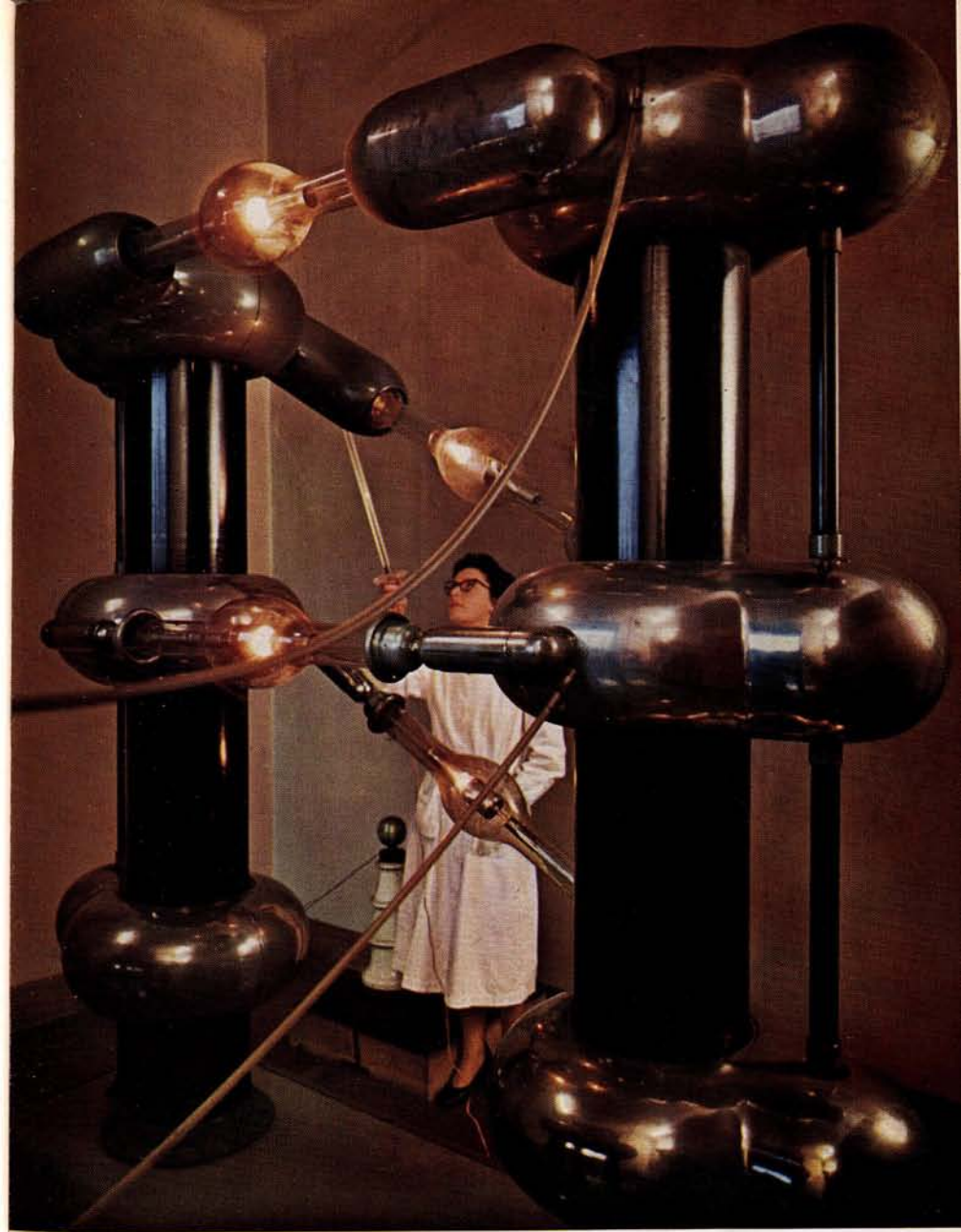
La parte A. T. dell'acceleratore Cockcroft e Walton da 400 keV (Laboratorio di Fisica Nucleare).
